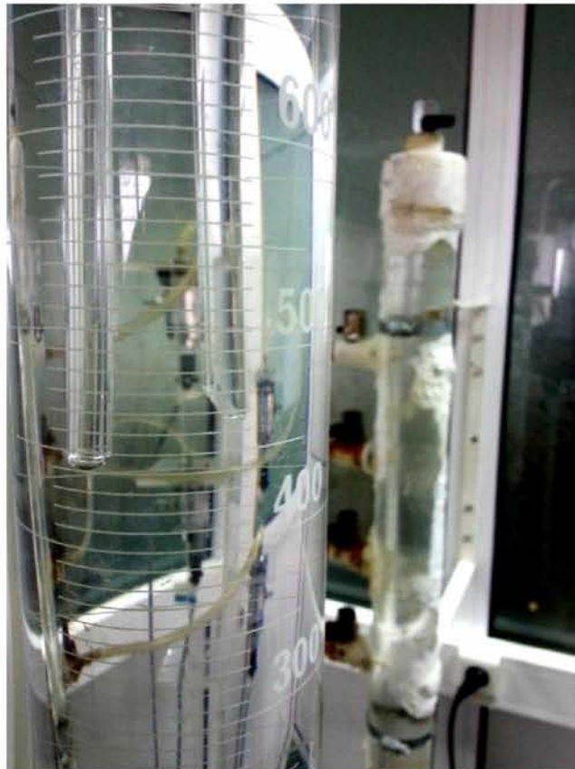
Εικόνα 8. Σημείο ατμοσφαιρικής πίεσης στη συσκευή Mariotte.
