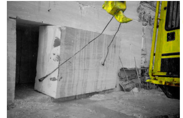
Εικόνα 5: Απομάκρυνση του πρώτου πάγκου με νύχι κατά την έναρξη της υπόγειας εκμετάλλευσης
