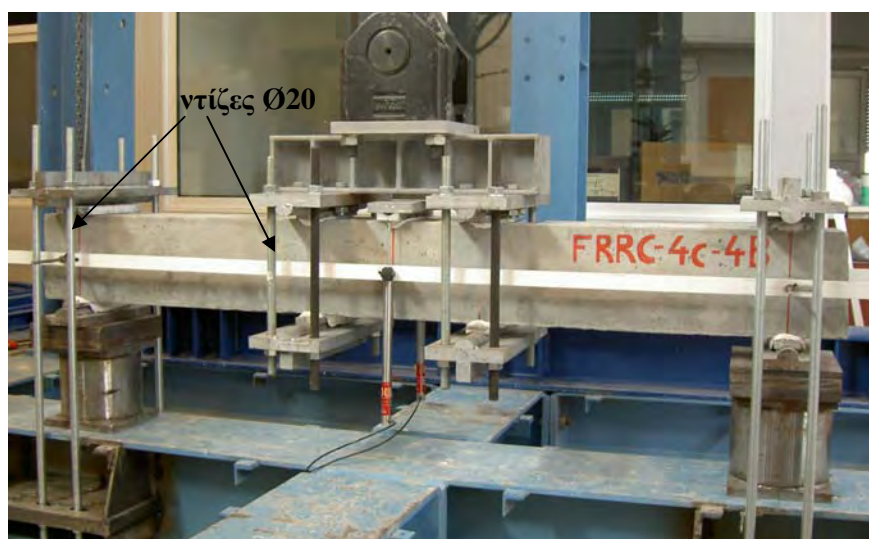
Σχ. 5.4: Πειραματική διάταξη για δοκούς σε κάμψη τεσσάρων σημείων υπό στατική ανακυκλιζόμενη φόρτιση.
