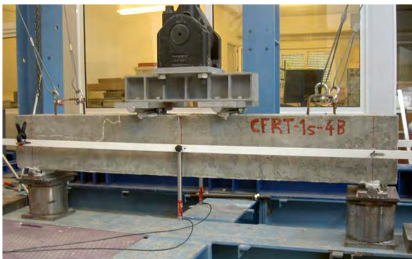
Σχ. 6.5: Πειραματική διάταξη για ενισχυμένη δοκό σε κάμψη τεσσάρων σημείων υπό στατική μονοτονική φόρτιση.
