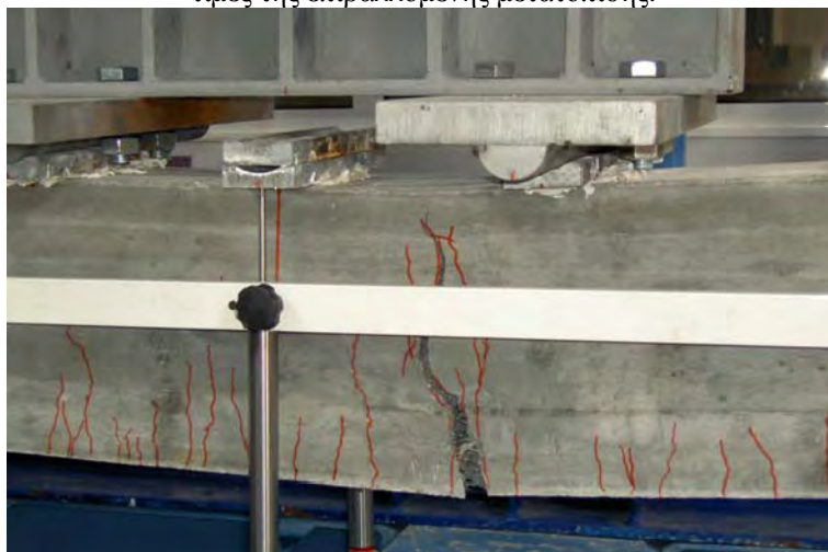
Σχ. 5.21: Εικόνα αστοχίας της δοκού ινοπλισμένου τσιμεντοκονιάματος χωρίς συμβατικό οπλισμό (Τύπος Β) στην πειραματική δοκιμή στατικής μονοτονικής κάμψης τεσσάρων σημείων.
