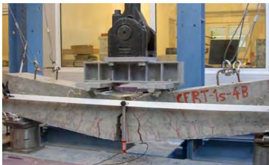
Σχ. 6.13: Εικόνα αστοχίας της ενισχυμένης δοκού Μ1 στην πειραματική δοκιμή στατικής μονοτονικής κάμψης τεσσάρων σημείων.
