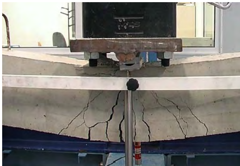
Σχ. 5.12: Εικόνα αστοχίας της συμβατικής δοκού Ο/Σ (Τύπος Α) στην πειραματική δοκιμή στατικής μονοτονικής κάμψης τριών σημείων.
