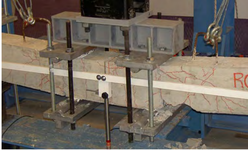
Σχ. 5.17: Εικόνα αστοχίας της συμβατικής δοκού Ο/Σ (Τύπος Α) στην πειραματική δοκιμή στατικής ανακυκλιζόμενης κάμψης τεσσάρων σημείων.
