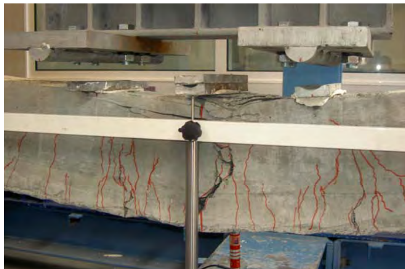
Σχ. 5.32: Εικόνα αστοχίας της δοκού ινοπλισμένου τσιμεντοκονιάματος με συμβατικό οπλισμό (Τύπος Γ) στην πειραματική δοκιμή στατικής μονοτονικής κάμψης τεσσάρων σημείων.
