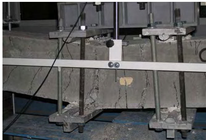
Σχ. 6.20: Εικόνα αστοχίας της ενισχυμένης δοκού M1 στην πειραματική δοκιμή στατικής ανακυκλιζόμενης κάμψης τεσσάρων σημείων.
