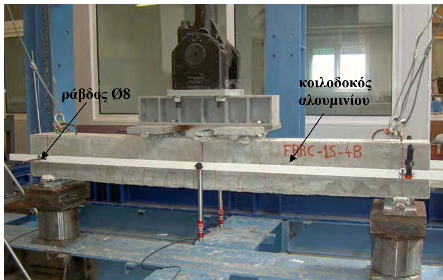
Σχ. 5.3: Πειραματική διάταξη για δοκούς σε κάμψη τεσσάρων σημείων υπό στατική μονοτονική φόρτιση.
