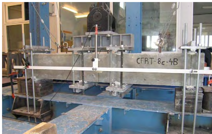
Σχ. 6.6: Πειραματική διάταξη για ενισχυμένη δοκό σε κάμψη τεσσάρων σημείων υπό στατική ανακυκλιζόμενη φόρτιση.
