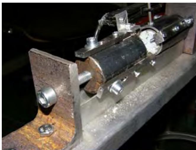
Σχ. 4.7: Η πειραματική διάταξη των δοκιμών εξόλκευσης.
