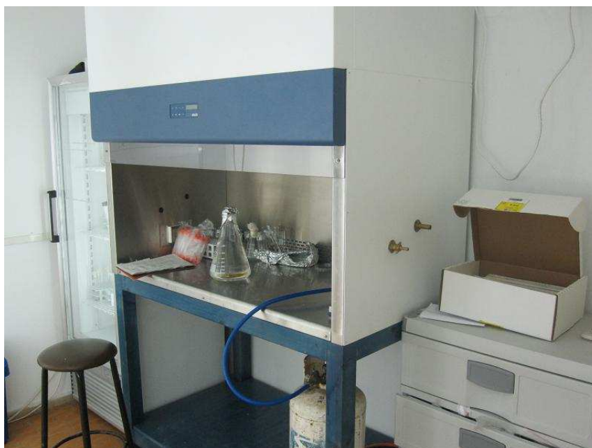
Εικόνα 6. Αποστειρωμένος χώρος εργασίας (Laminar flow) για διαχείριση των καλλιιεργειών υπό ασηπτικές συνθήκες. Διακρίνεται στη βάση, η φιάλη υγραερίου για την χρήση του αυτόκαυστου (πηγή: φωτογραφία από τον συγγραφέα).
