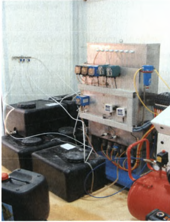
Εικόνα 15. Ο υδρολιπαντήρας και οι δεξαμενές με τα πυκνά διαλύματα, για την παρασκευή των θρεπτικών διαλυμάτων.
