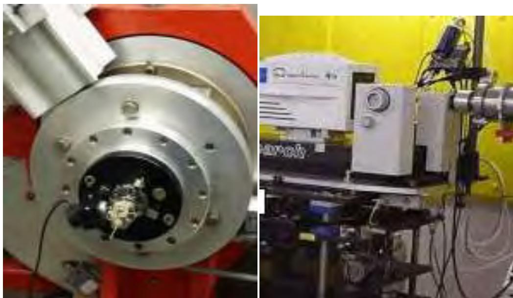
Σχήμα 20: Συσκευές κρυσταλλογραφίας ακτίνων X του εργαστηρίου Daresbury (Daresbury Laboratory, Warrington England). Αριστερά: γωνιόμετρο τοποθετημένο στη ειδική θέση.
