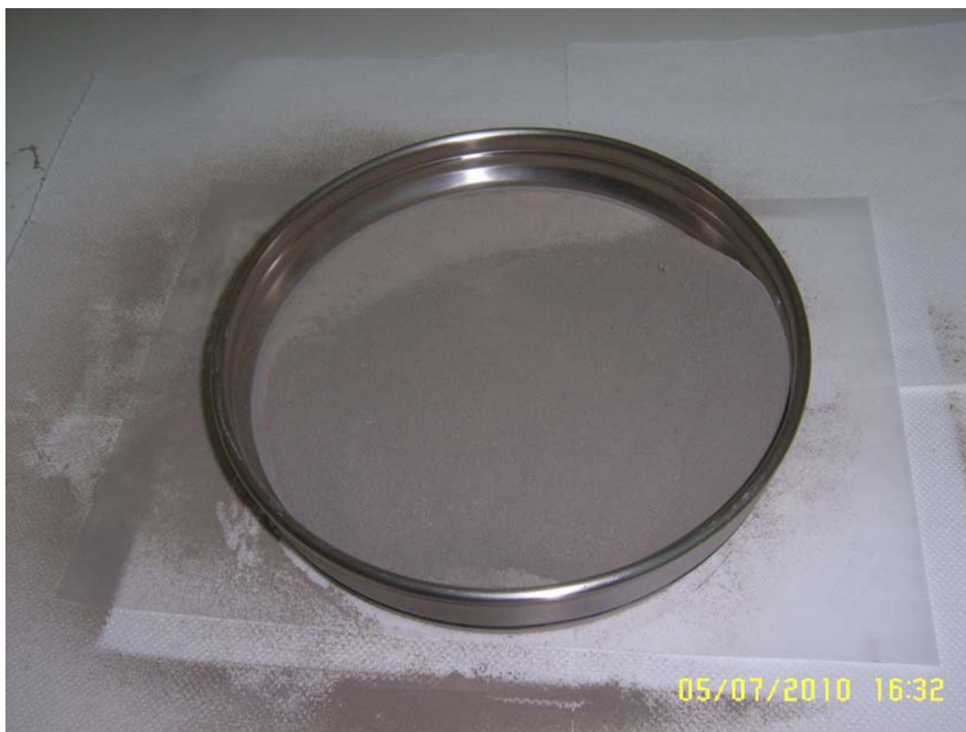
Εικόνα 2.10: Επεξεργασία δειγμάτων σε κόσκινο.
