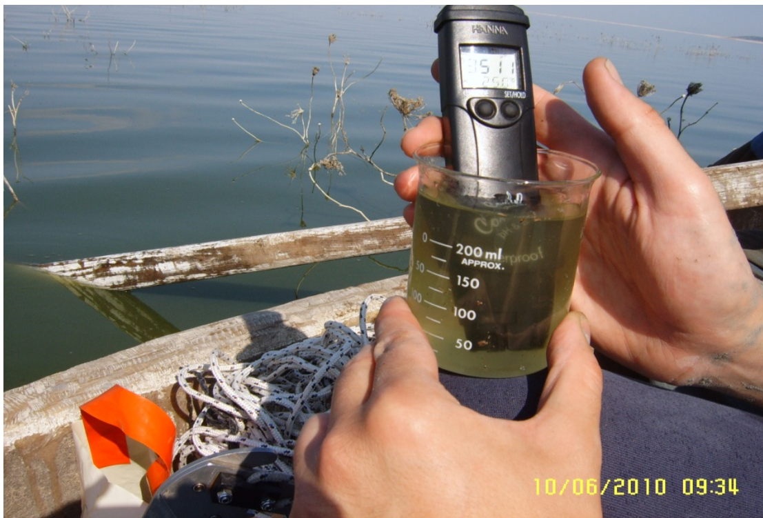
Εικόνα 2.4: Ειδικό όργανο μέτρησης TDS και αγωγιμότητας (Combo by Hanna).
