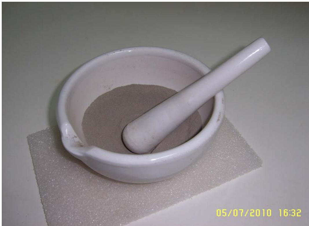
Εικόνα 2.9: Επεξεργασία δειγμάτων σε γουδί πορσελάνης.
