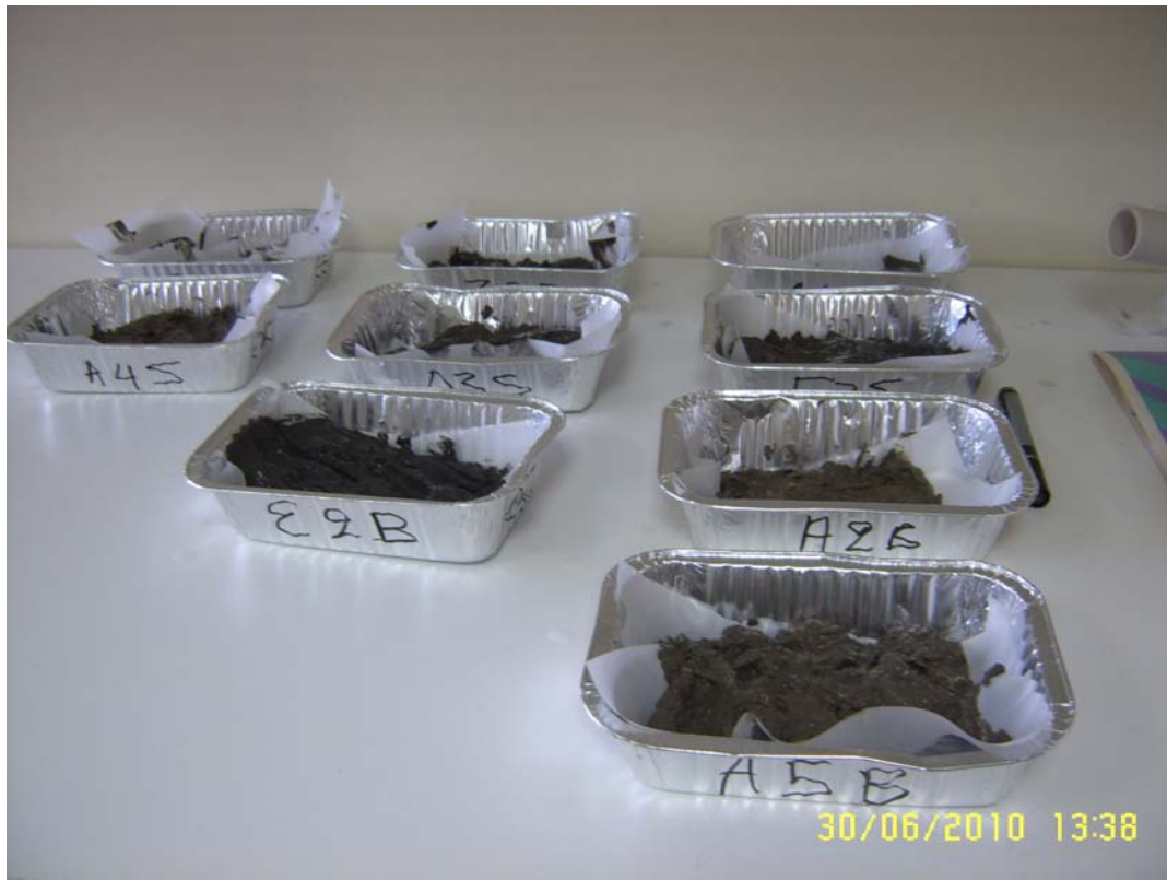
Εικόνα 2.8: Τοποθέτηση δειγμάτων σε ταψάκια.
