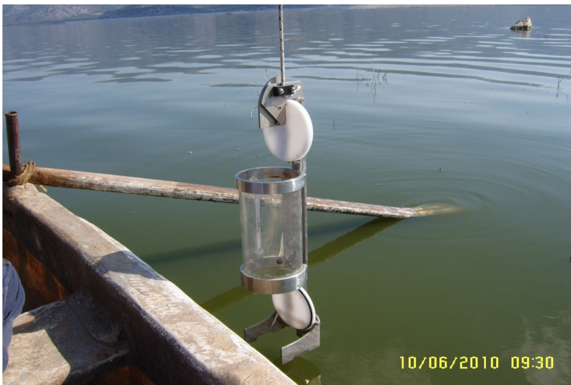
Εικόνες 2.1 και 2.2: Δειγματολήπτης νερού (Limnos Rossincatu 2 E 17 20380 Turku Finland).
