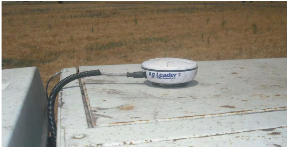
Σχήμα 5.3.1. Εγκατάσταση της κεραίας του GPS 1500 στην οροφή της καμπίνας.
