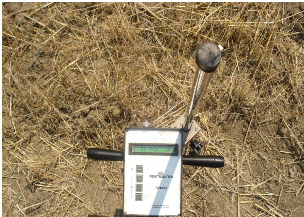
5.5.2. Διεσδυσιόμετρο soil penetrometer Bush SP1000 το οποίο έχει εισχωρήσει 50 cm.
