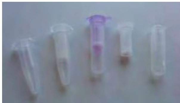
Εικόνα 5 : (από αριστερά προς τα δεξιά) Σωληνίσκος με καπάκι, λευκός σωληνίσκος με καπάκι και φίλτρο, μωβ σωληνίσκος με καπάκι και φίλτρο, καπάκι από σωληνίσκο με το φίλτρο του και σωληνίσκος χωρίς καπάκι
