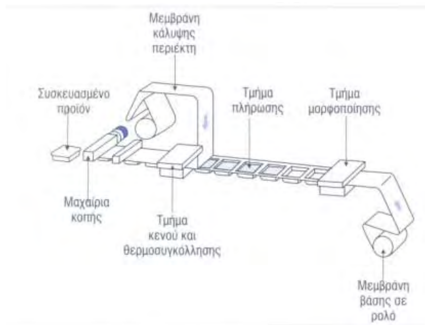
Σχήμα 3.6.1 Σχηματική απεικόνιση συσκευαστικής μηχανής (Μπλούκας, 2004)
