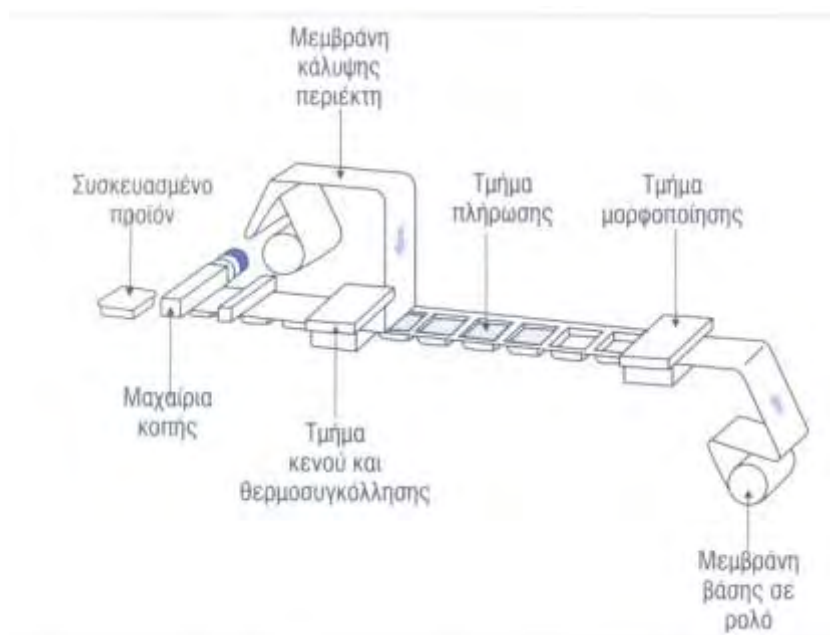
Σχήμα 3.6.1 Σχηματική απεικόνιση συσκευαστικής μηχανής (Μπλούκας, 2004)
