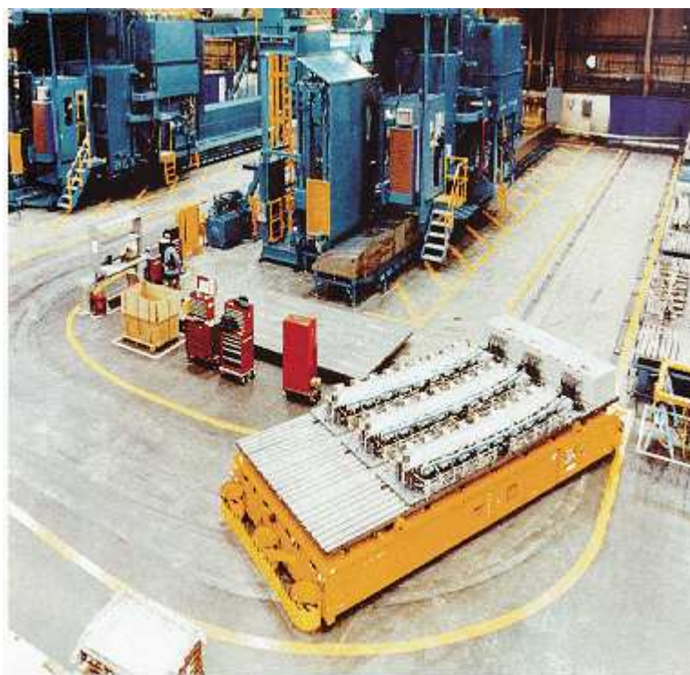
Εικόνα 2: Ρομπότ περιορισμένης κίνησης σταθερής τροχιάς σε χώρο εργασίας (Automatic Guided Vehicles)
