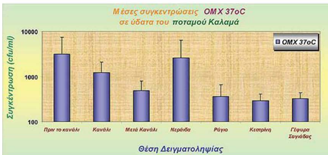
Σχήμα 8. Μέσες συγκεντρώσεις OMX 37°C σε ύδατα του Καλαμά (Ecosystems Database Observatory 2007)
