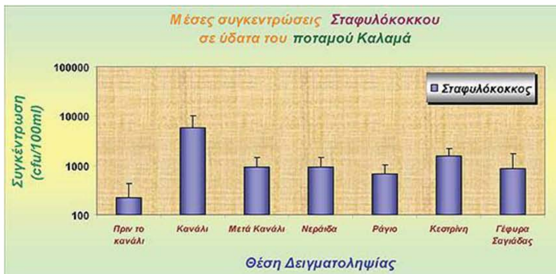
Σχήμα 9. Μέσες συγκεντρώσεις Σταφυλόκοκκου σε ύδατα του Καλαμά (Ecosystems Database Observatory 2007)
