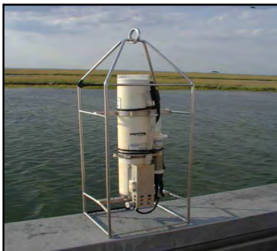
Εικόνα 2.2: Αυτογραφικό όργανο CTD ( http://marine.rutgers.edu/mrs/nopp/photogal/photoju1.htm )
