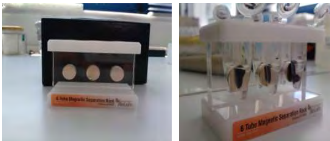
Εικόνα 12. α) μαγνητικό πεδίο β) Διαχωρισμός υλικού από τα διαλύματα (washing buffer) μέσω μαγνητικού πεδίου.
