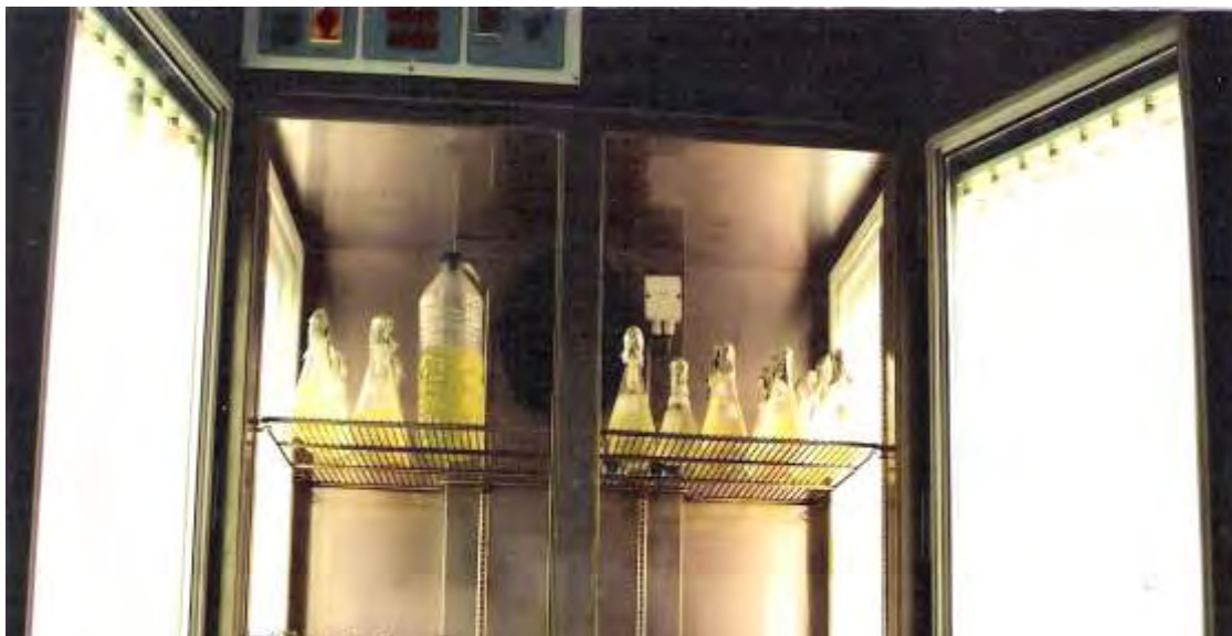
Εικόνα 2.5: Καλλιέργεια φυτοπλαγκτού σε ειδικό θάλαμο υπό σταθερές συνθήκες καλλιέργειας και φωτισμό έντασης 3000Lux (επωαστήρας CDR).
