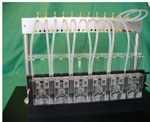
Εικ. 9: Η αντλία τύπου Ussing που χρησιμοποιήθηκε στην πειραματική διαδικασία.
