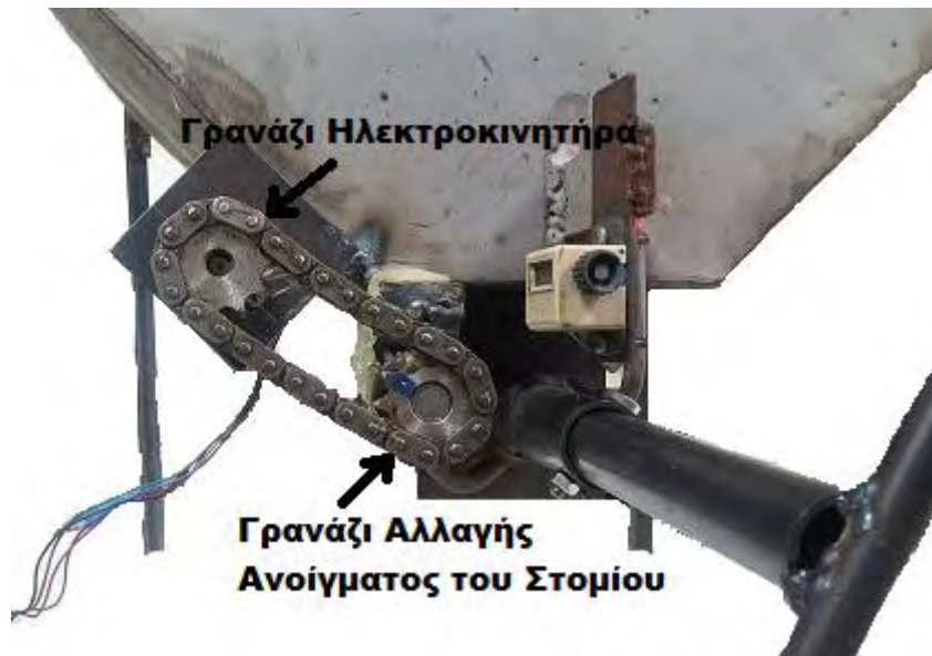
Εικόνα 25: Στο λιπασματοδιανομέα, ο κοχλίας για την μεταβολή του ανοίγματος του στομίου του μετρητικού μηχανισμού, αντικαταστάθηκε από γρανάζι, το οποίο με την σειρά του ενώθηκε με το γρανάζι του άξονα του ηλεκτροκινητήρα. Κατά συνέπεια, ο ηλεκτροκινητήρας είναι υπεύθυνος για το άνοιγμα του στομίου.
