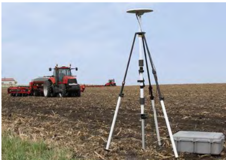
Εικόνα 11: RTK-GPS, Σταθερός σταθμός διόρθωσης σφάλματος
