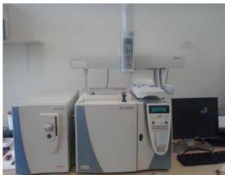
Εικόνα 21: GC-MS: Σύστημα αέριου χρωματογράφου Trace GC με φασματογράφο μαζών Polaris Q και αυτόματη δειγματοληψία πολλών δειγμάτων.
