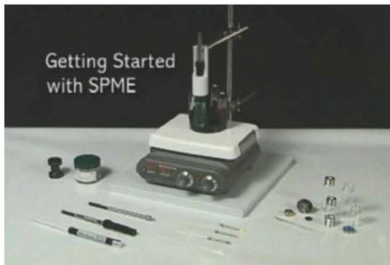
Εικόνα 25: Γενική εικόνα της συσκευής μικροεκχύλισης στερεάς φάσης και εξαρτημάτων της
