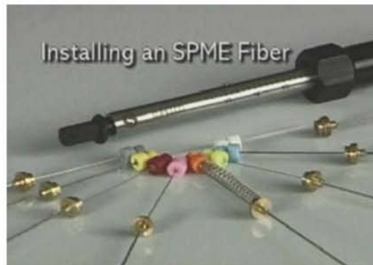
Εικόνα 26: Εξοπλισμός του ατσάλινου εμβόλου (holder) με την ίνα τετηγμένου πυριτίου που έχει επικάλυψη πολυμερούς.
