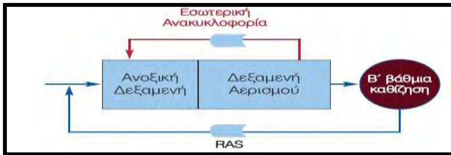
Σχήμα 3 : Χωριστικές δεξαμενές νιτροποίησης – απονιτροποίησης (Ο.Ε.Ε.Λ.Σ. 2006)
