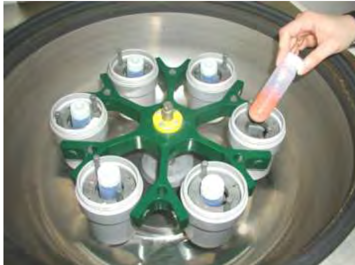
Εικόνα 9: Τοποθέτηση σωλήνων στη συσκευή φυγοκέντρησης
