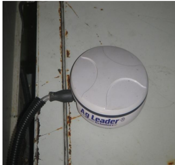
Σχήμα 4.3.1 Εγκατάσταση του GPS 1500 στην οροφή της καμπίνας.
