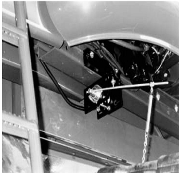
Σχήμα 2.4.7 Αισθητήρας θέσης μηχανισμού θερισμού.
