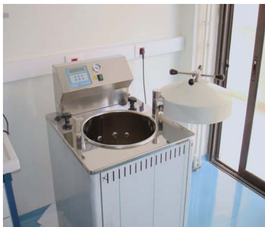
Εικ.8 Κλίβανος αποστείρωσης που χρησιμοποιήθηκε κατά την παραγωγή υποστρωμάτων.
