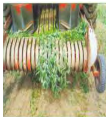
ΕΙΚΟΝΑ 21. Πρώτο τμήμα συλλογής και προώθησης φυτών αρακά για εκκοκκισμό μηχανής
