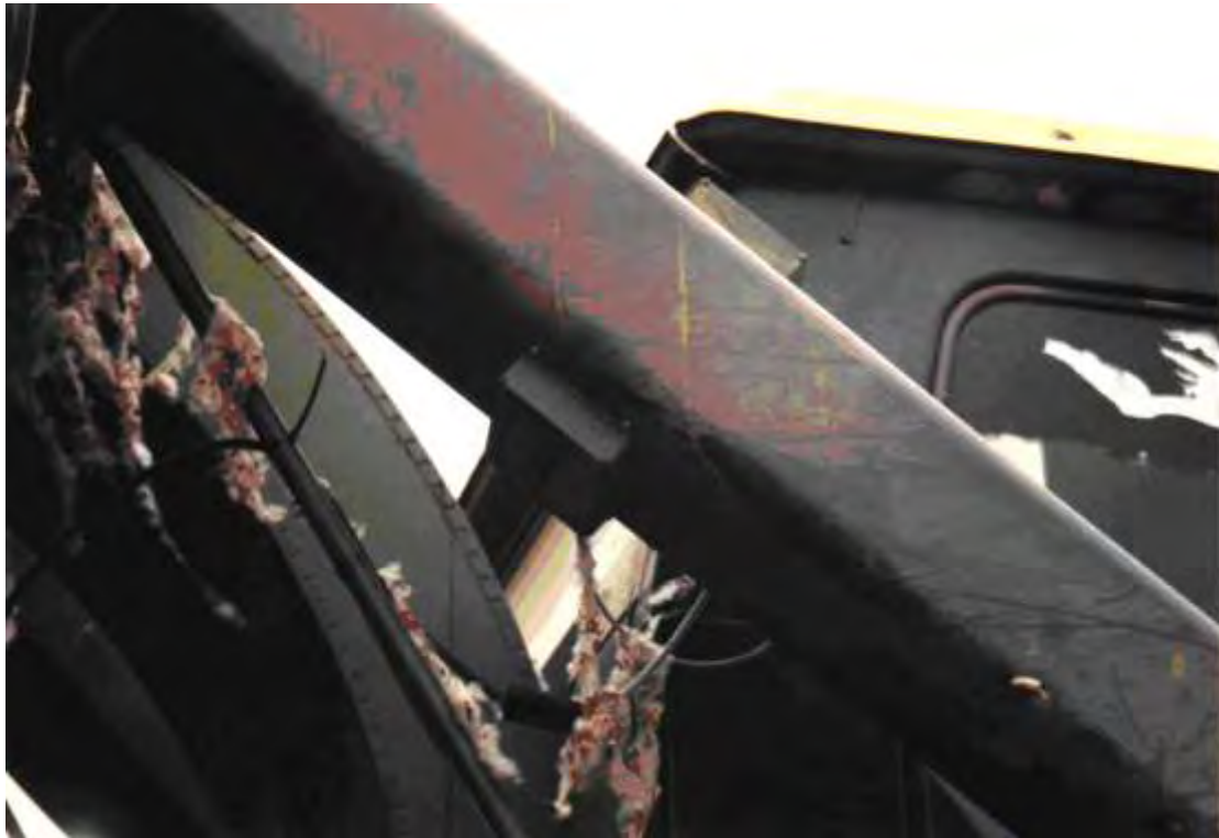
Σχήμα 19. Πομπός και δέκτης υπέρυθρων αισθητήρων που εγκαθίστανται στο σωλήνα μεταφοράς του βαμβακιού προς το καλάθι
