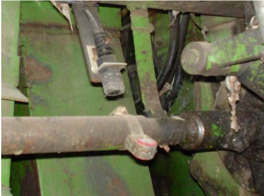
Σχήμα 20. Αισθητήρας μέτρησης ταχύτητας εργασίας
