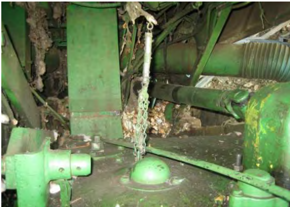
Σχήμα 21. Διακόπτης On/Off στο ψαλίδι των μονάδων συλλογής
