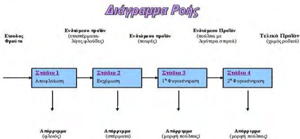
Εικόνα 33: Ενδεικτικό συνοπτικό διάγραμμα ροής της διαδικασίας παραγωγής φρέσκου χυμού ροδιού από την οποία προήλθαν τα εκχυλίσματα ροδιού που εξετάσαμε. Εδώ απεικονίζονται τα ενδιάμεσα προϊόντα και απορρίμματα των 4 πρώτων σταδίων.(από αυτήν τη διαδικασία παρήχθησαν τα 9 πρώτα εκχυλίσματα ροδιού (διπλωματική εργασία Μοσχοβίδη).
