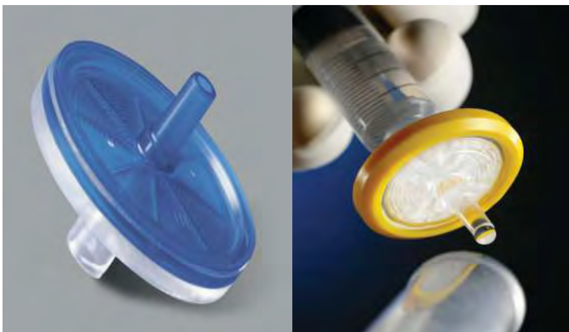
Εικόνα 37: Το φίλτρο το οποίο χρησιμοποιήθηκε με διάμετρο 20μm(αριστερά). Τρόπος χρήσης σύριγγας και φίλτρου ώστε να φιλτραριστούν τα εκχυλίσματα σταφυλιού(δεξιά).
