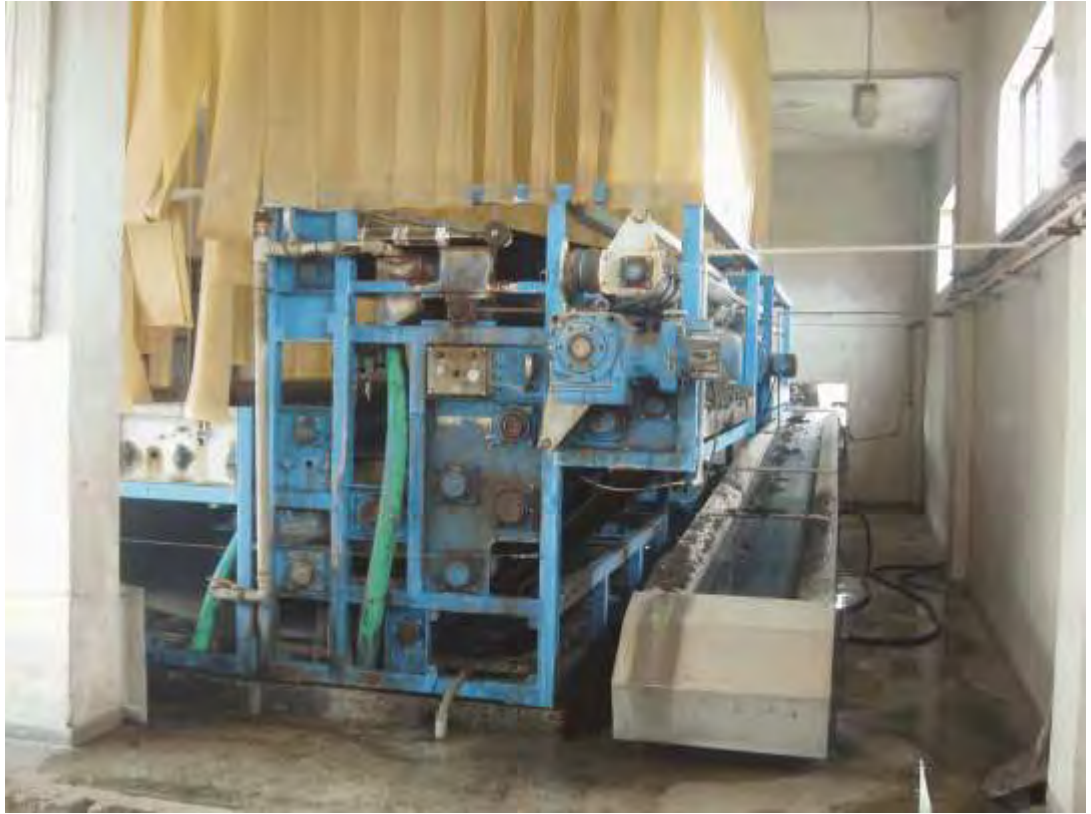
Εικόνα 13 Αφυδάτωση Ιλύος με Ταινιοφιλτρώπρεςσες
