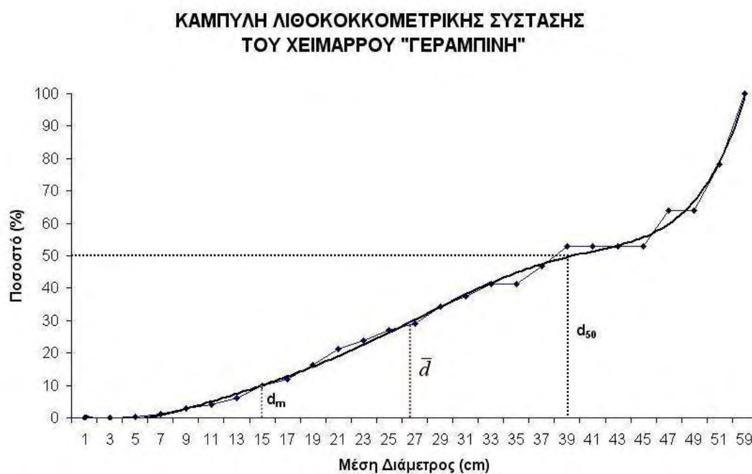
Εικόνα 71: Σχεδιάγραμμα της λιθοκοκκομετρικής κατανομής του χειμάρρου «Γεραμπίνη»
