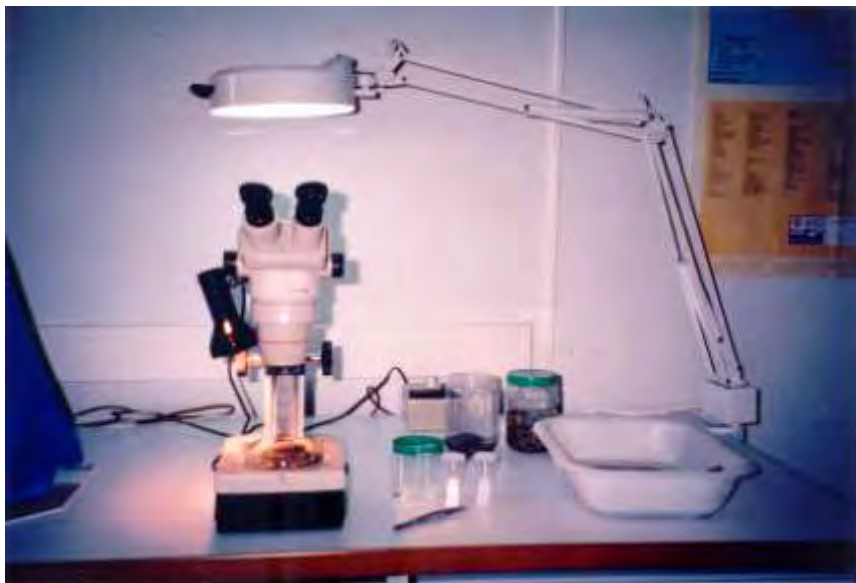
Εικόνα 8: Το στερεοσκόπιο της OLYMPUS (φακός: SZ40) που χρησιμοποιήθηκε, για τον υπολογισμό, μέτρηση και κατάταξη του ζωοβένθους σε είδη
