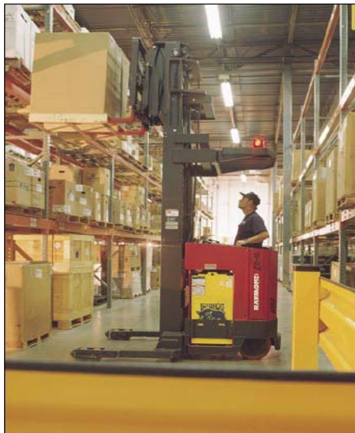
Εικόνα 2. Περωνοφόρο όχημα κατά την ανύψωση παλέτας
