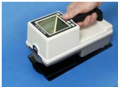
Εικόνα 35. Βαθμονόμηση με τη μαύρη γυάλινη πλάκα
