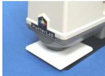
Εικόνα 36. Βαθμονόμηση με τη λευκή πλάκα
