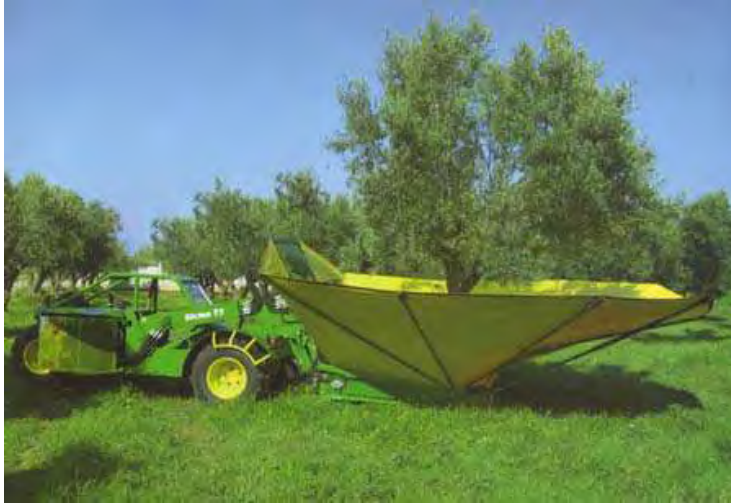
Αυτοκινούμενο μηχάνημα με βραχίονα που ταυτόχρονα συλλέγει τον καρπό
