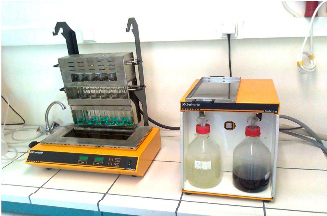
Εικόνα 9 Σύστημα καύσης και εξατμιστής. Προσωπικό αρχείο.
