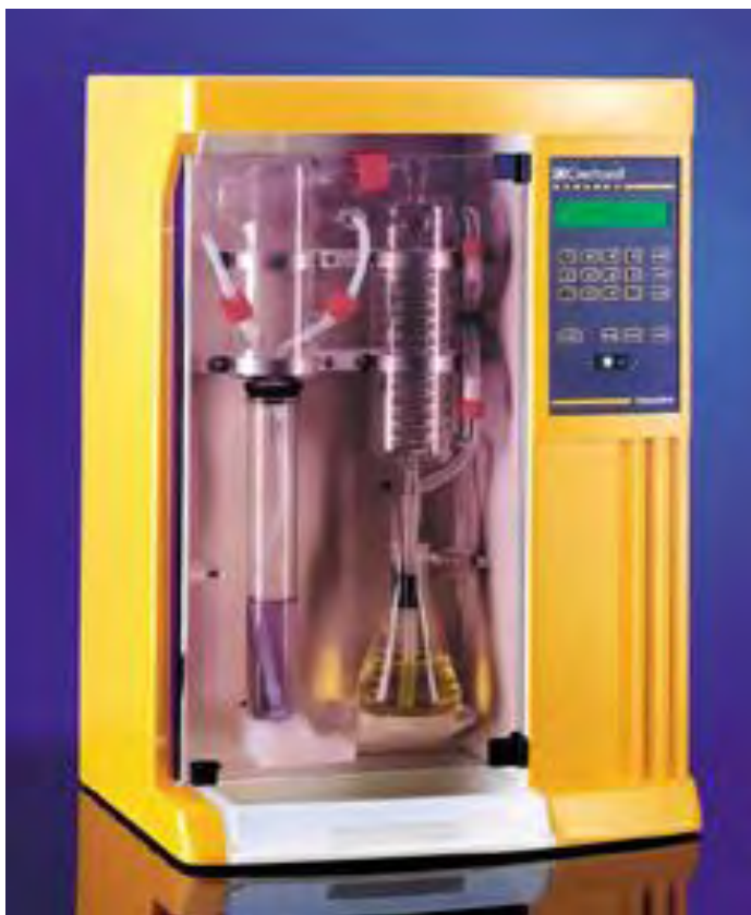
Εικόνα 10 Αποστακτική συσκευή Varodest VAP-12, C. Gerhard (Π.Α. 3)
