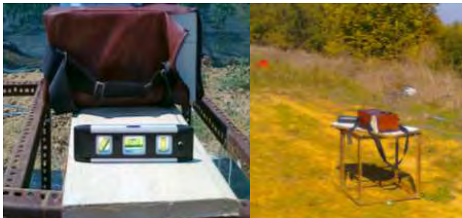
Εικόνα 11. Οριζοντίωση του οργάνου (αριστερά) και πραγματοποίηση εξωτερικής μέτρησης (δεξιά).
