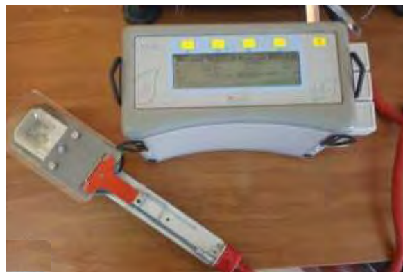
Εικόνα 12. Το σύστημα LCpro+ μέτρησης της φωτοσύνθεσης.
