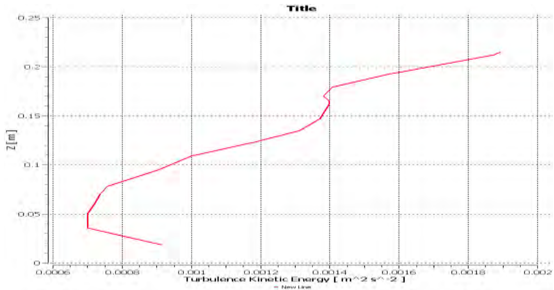
Σχήμα 5.36 Προφίλ τυρβώδους κινητικής ενέργειας για το πλέγμα 3 στο μέσο του δεξιού τοιχώματος
