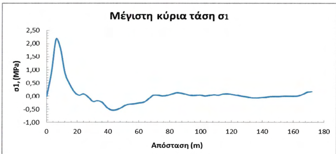
Σχήμα 5.2.13: Κατανομή μέγιστης κύριας τάσης \sigma_1 κατά μήκος της πλάκας 7 μετά την πλήρωση της λεκάνης.
