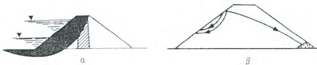
Σχ. 2.9 Ανάντη πρανές α) Πιθανός κύκλος ολίσθησης όταν ο ταμιευτήρας είναι γεμάτος. β) Γραμμές ροής κατά την εκκένωση του ταμιευτήρα.
