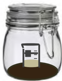
Εικόνα 10: Γυάλινο δοχείο με αεροστεγώς εφαρμζόμενο καπάκι (βάζο), που περιέχει το εδαφικό δείγμα και την παγίδα με το NaOH.
