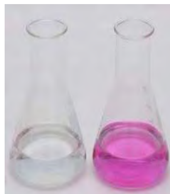
Εικόνα 11: Δεξιά, το διάλυμα πριν την τιτλομέτρηση. Αριστερά, το διάλυμα μετά την εξουδετέρωση.
