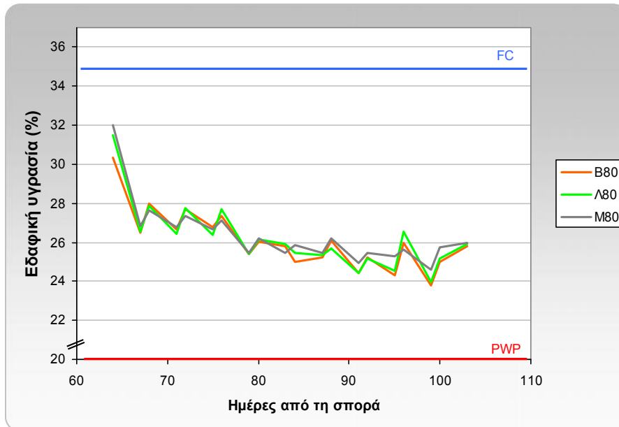
Σχήμα 4.10: Μέσοι όροι τριετίας της εδαφικής υγρασίας στο βάθος 0-30 cm, στις μεταχειρίσεις που αρδεύονταν με δόση άρδευσης ίση με το 80% της ημερήσιας εξατμισοδιαπνοής της καλλιέργειας.
