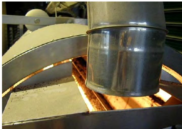
Εικόνα 2.11: Ο απαγωγός θερμότητας του επεξεργαστή.
