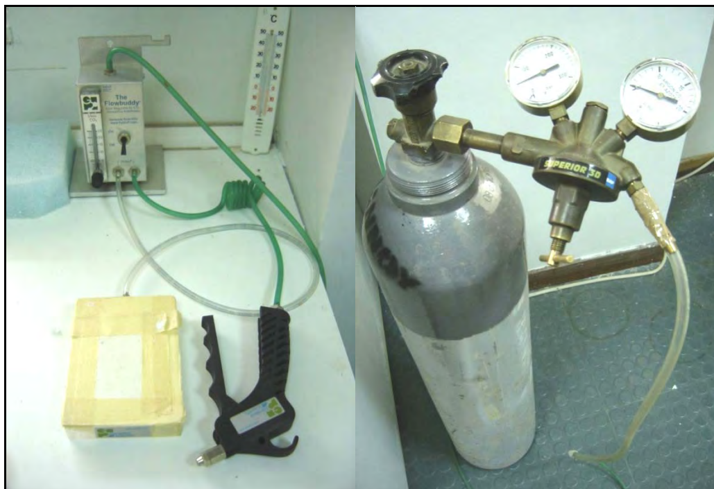
Εικόνα 2.7. Σύστημα αναισθητοποίησης ενηλίκων της μύγας της Μεσογείου με CO 2 .
