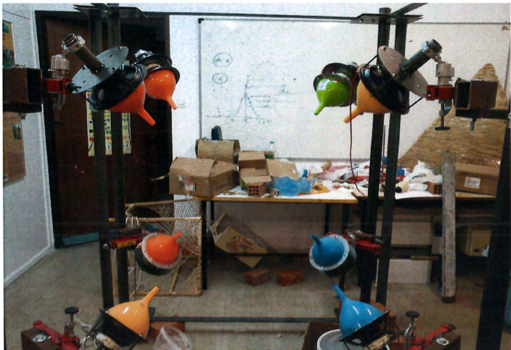
Εικόνα 1- Τοποθετημένα ηχεία στο πλαίσιο
