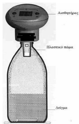
Σχήμα 13.19: Συσκευή μέτρησης BOD 5
