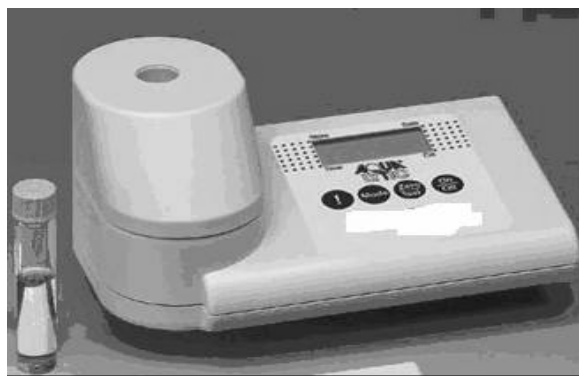
Σχήμα 13.21: Φασματοφωτόμετρο μέτρησης COD
