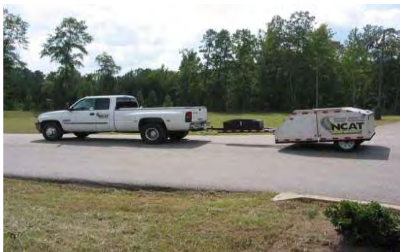
Ρυμουλκούμενο και ρυμουλκό στη μέθοδο Close-Proximity
