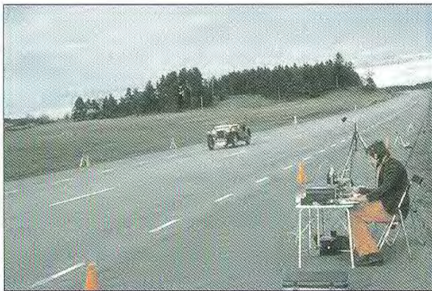
Εξοπλισμός μετρήσεων κι η διάταξή του στη μέθοδο Coast-By
