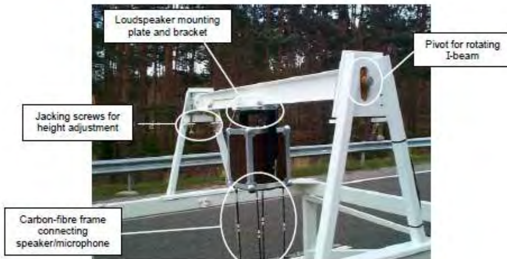
Διάταξη του μεγαφώνου και του ενισχυτή στο σκελετό του τρέιλερ
