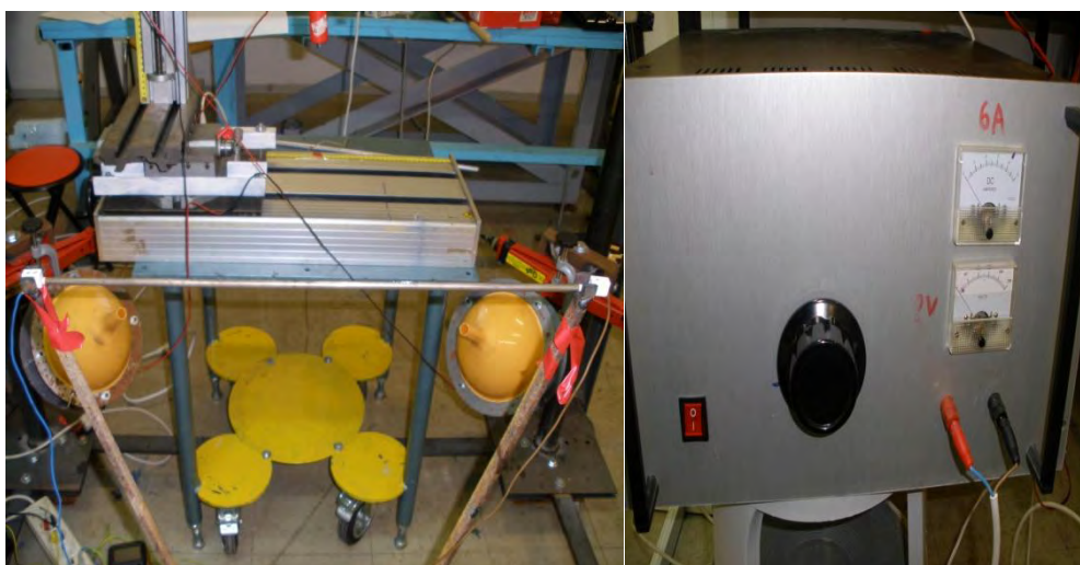
Εικόνα 4.1 α) αντίσταση d=6.5 mm β) γεννήτρια συνεχούς ρεύματος
