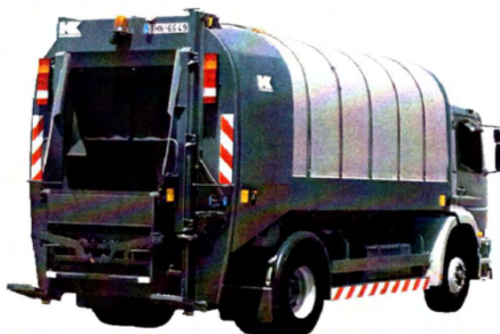
Σχήμα2.2 Απορριματοφόρο τύπου περιστρεφόμενου τυμπάνου
