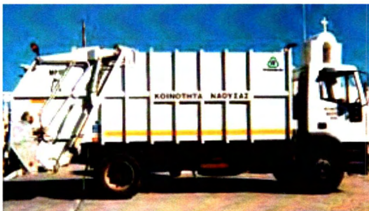
Σχήμα2.1 Απορριματοφόρο τύπου πρέσσας.
