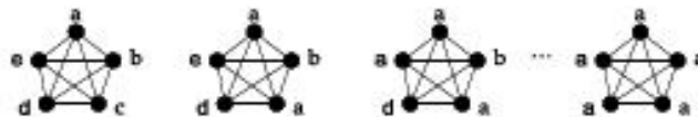
Σχήμα 3.1: Οι κόμβοι ενημερώνονται ο ένας μετά τον άλλον καθώς προχωράμε από αριστερά προς τα δεξιά. Λόγω της υψηλής πυκνότητας των κόμβων ( η μεγαλύτερη δυνατή σε αυτή την περίπτωση) όλοι οι κόμβοι αποκτούν την ίδια ετικέτα [2].
