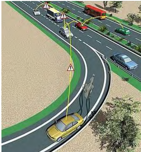
Εικόνα 3-Ενημέρωση γειτονικών οχημάτων για πρόβλημα στο οδόστρωμα
