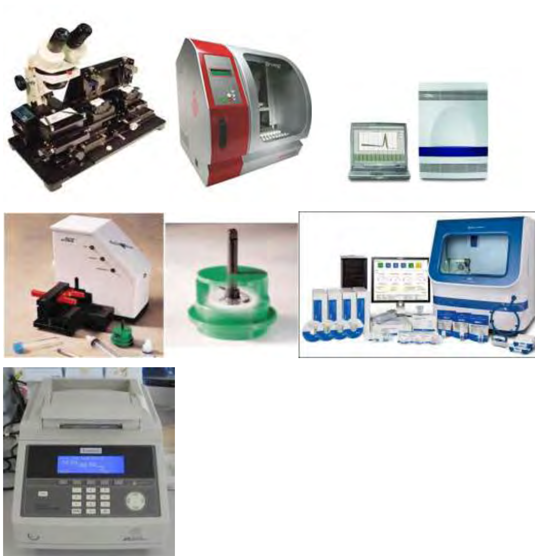
Εικόνα 18: Στην εικόνα αυτή φαίνονται τα όργανα που χρησιμοποιήθηκαν. Στην πρώτη σειρά → Αριστερά: Advanced Tissue Arrayer ATA-100, στην μέση: Extraction DNA iPrep™ invitrogen, δεξιά: 7500 Fast Real Time PCR System Applied Biosystem, στην δεύτερη σειρά → Αριστερά: BD™ Medimachine system, δεξιά: Γενετικό Αναλυτή 3500 της Applied Biosystems (8-capillary DNA Sequencer). Στην τρίτη σειρά → 9700 PCR machine.
