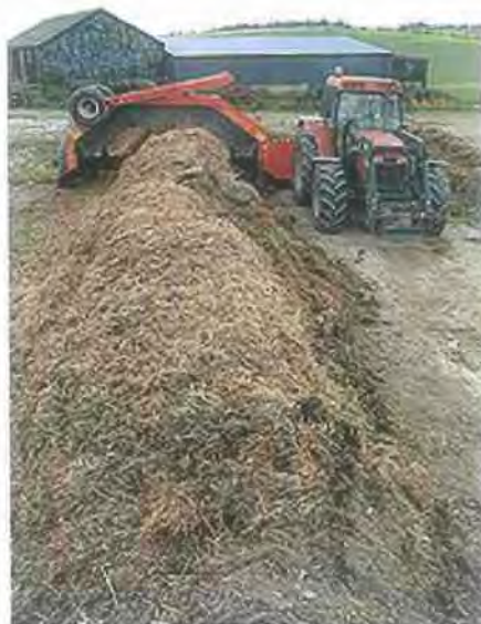
Εικόνα 1.5 Μηχανική ανάδευση κομποστοποιημένων απορριμμάτων
