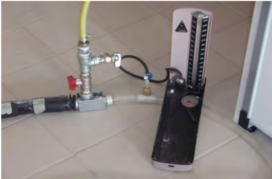
Εικόνα 2.4: Πιεσόμετρο συνδεδεμένο με την τρίοδο κάνουλα στο σημείο 1 (Αγωγός A1). Το κάθετο στέλεχος προς την επιφάνεια του εδάφους χρησιμοποιήθηκε για πλήρωση με νερό αλλά και για εξαέρωση.
