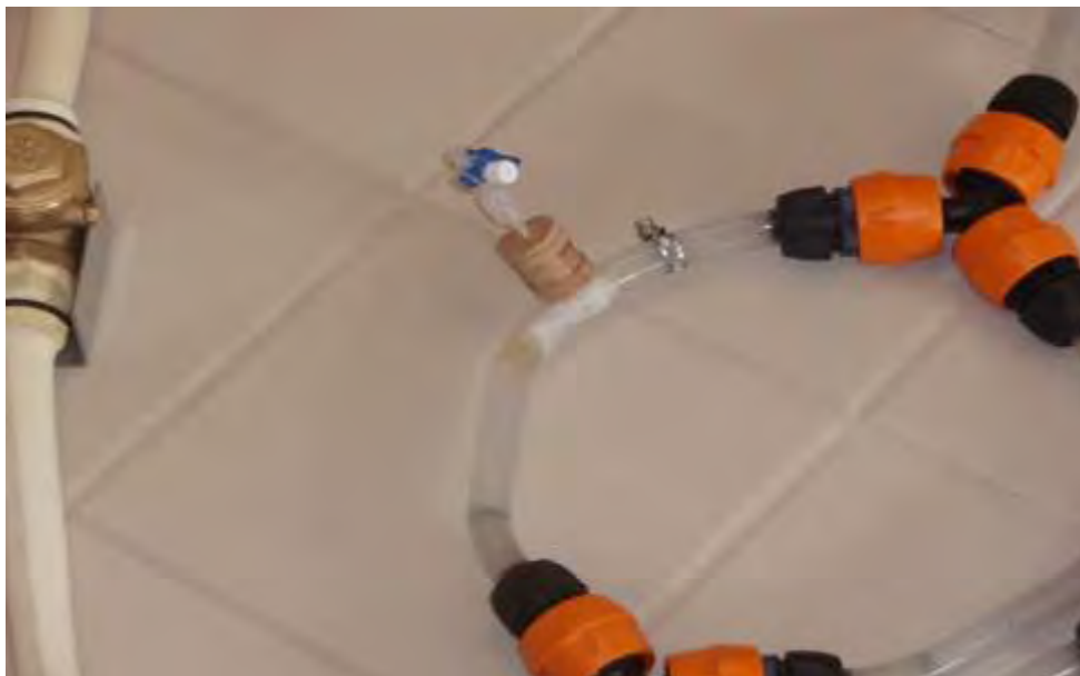
Εικόνα 2.5: Τρίδος κάνουλα τοποθετημένη στο σημείο 3 πριν τα τριχοειδή.
