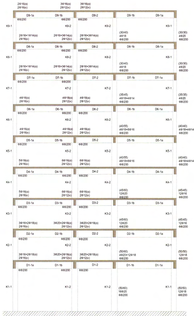
Σχήμα 41. Οπλισμός εννιαόροφου κτιρίου
